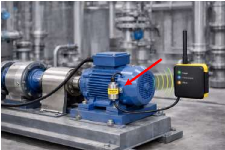
Figure 1. Moteur équipé d'un capteur de vibrations. Image générée à partir de la requête « Moteur équipé d'un capteur de vibrations » par OpenAI, ChatGPT, 2026.
